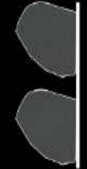
Las paredes laterales verticales, las alas y los fondos perpendiculares de otros cangilones impiden el flujo de los productos dentro y fuera del cangilón.
